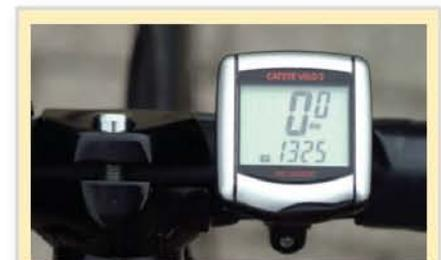
Der Kilometerzähler misst die Anzahl der Umdrehungen eines Rades und zeigt die gefahrenen Kilometer an. Bei einem 25er-Reifen springt er immer nach 500 Umdrehungen um 1 Kilometer weiter.
